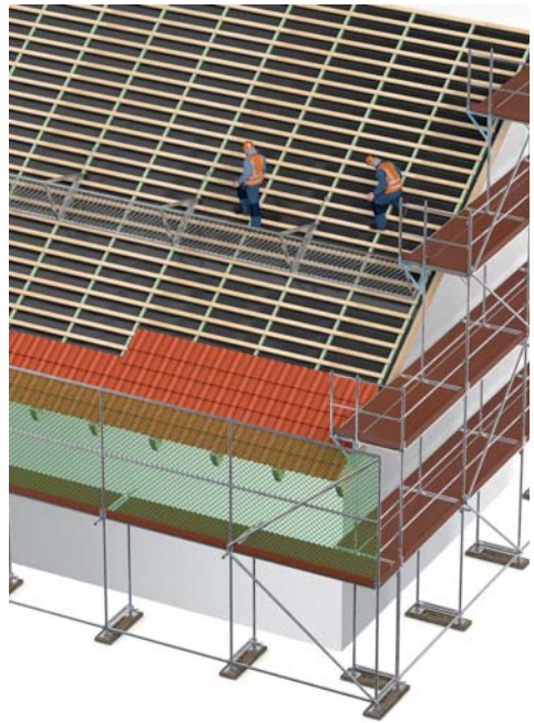
Technische Maßnahmen zum Auffangen von abstürzenden Personen (Quelle: BG BAU, Bausteine)
