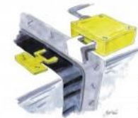
Abbildung 1 – Beispiel für eine manipulierte Schutzeinrichtung (hier: Turschalter mit Ersatzbetätiger)
